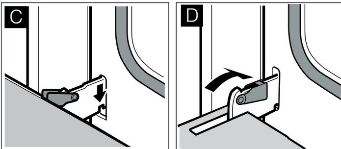
Die Gerätetür ist gesichert und kann nicht mehr ausgehängt werden.
